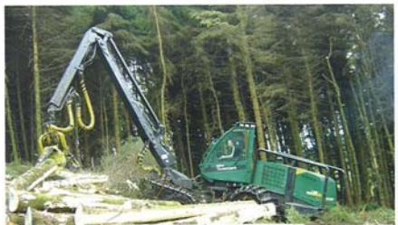
Sakarilla on kokemusta lähes kaikista Konemerkeistä, mutta Irlannissa päätyökäluuna oli John Deere 1270D varustettuna H480 -hakkuupäällä.
